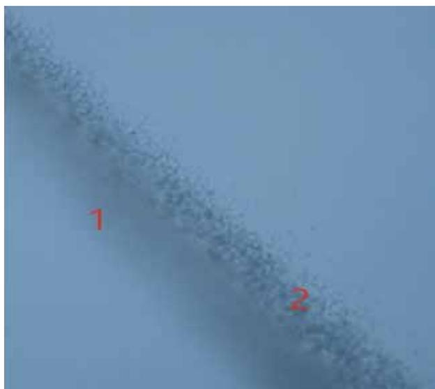
**Рис. 4.** Поперечный срез ИОЛ в области наибольшего помутнения: а) материал ИОЛ; б) кристаллиты на поверхности гидрофильного материала ИОЛ
